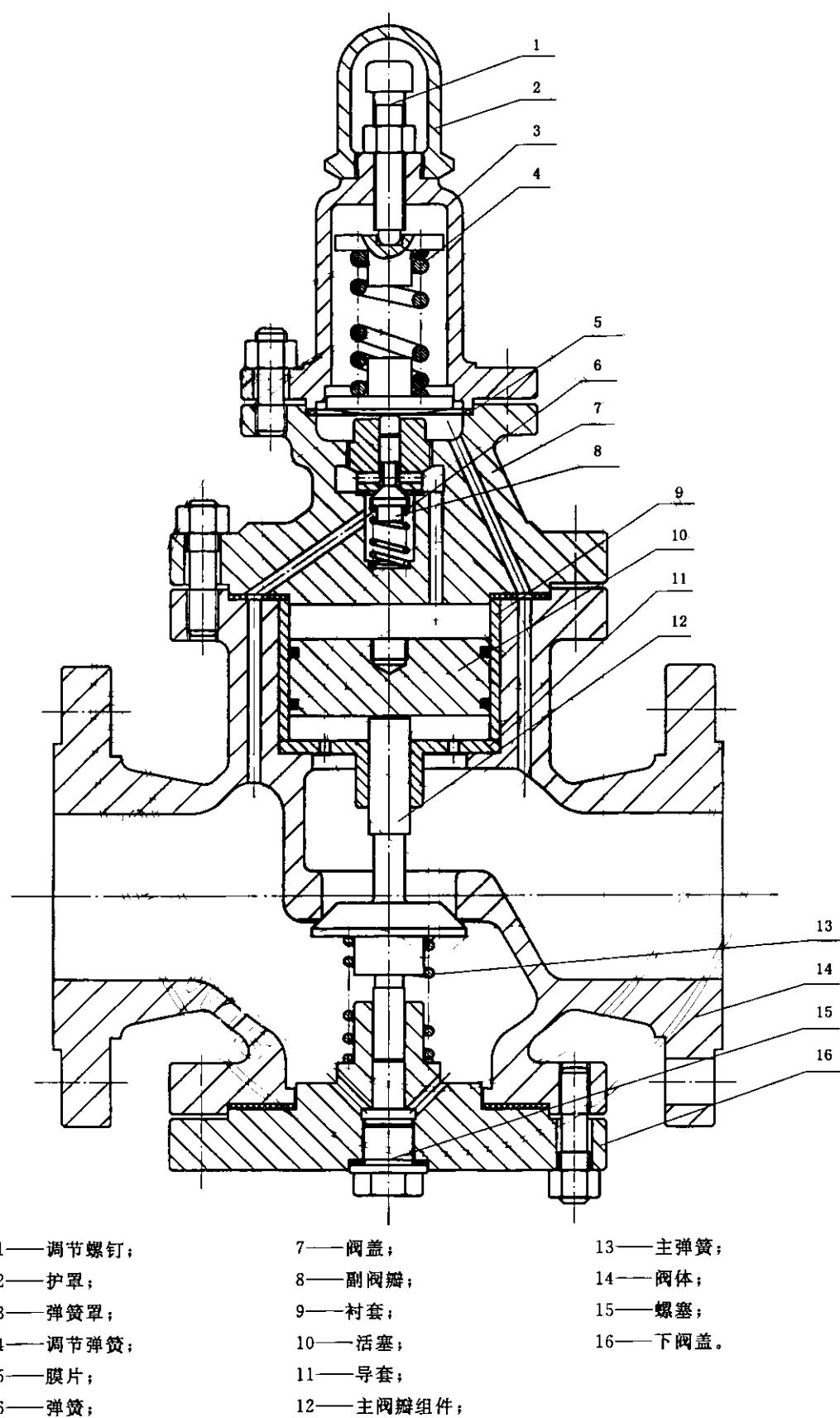
图 1 先导活塞式减压阀的典型结构
